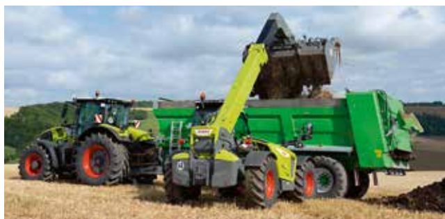
Die großen SCORPION Modelle 756 und 746 verfügen jetzt über eine Hydraulikleistung von 200 l/min.
