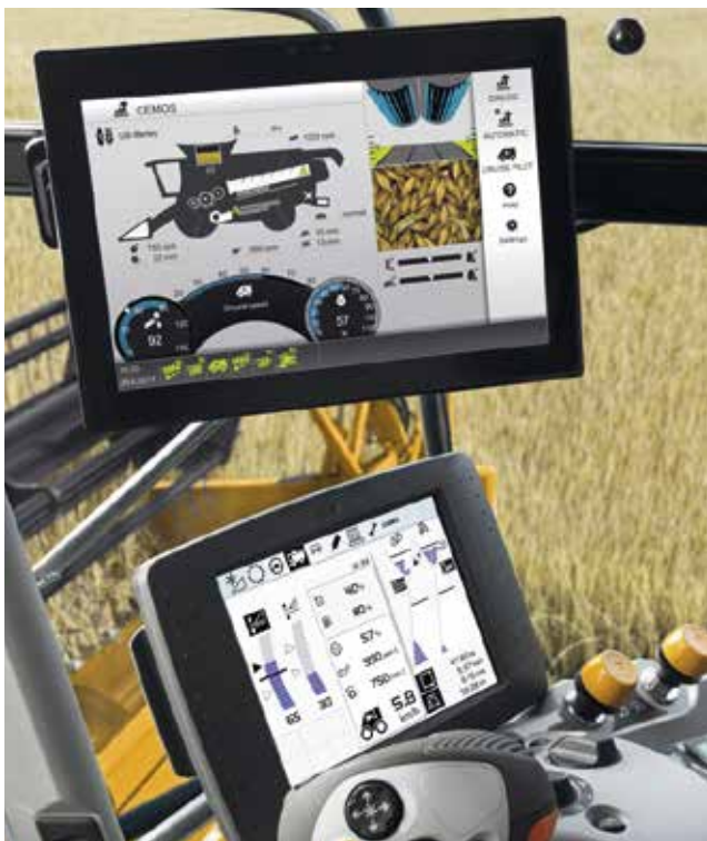
Die Bedienung von CEMOS AUTO THRESHING erfolgt über das neue Touchscreen-Terminal CEBIS MOBILE.
