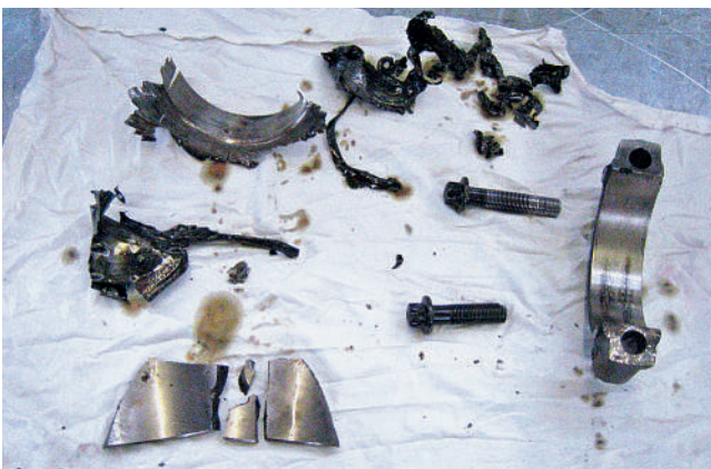
Сломанный шатунный подшипник с обломками втулки.
