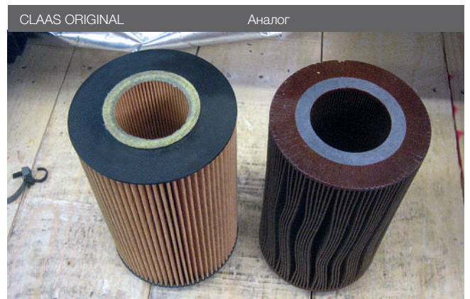
Слева показан новый фильтр CLAAS ORIGINAL, справа — поврежденный фильтр-аналог (время работы < 20 ч). При сравнении видно, что в фильтре-аналоге отсутствует уплотнение. Это приводит к внутренним утечкам, которые могут остаться незамеченными во время работы двигателя, поскольку давление масла сохраняется. Из-за этого фильтровальная бумага сжимается, что приводит к смятию фильтра
