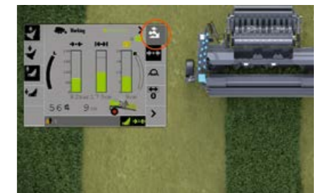
Pickup, PFS und der hintere Rollenniederhalter sind komfortabel aus der Kabine reversierbar.
