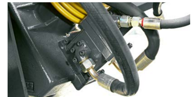
Zwei Ölpumpen versorgen das Eingangsgetriebe und das Knoterreinigungssystem TURBO FAN mit Hydrauliköl.
