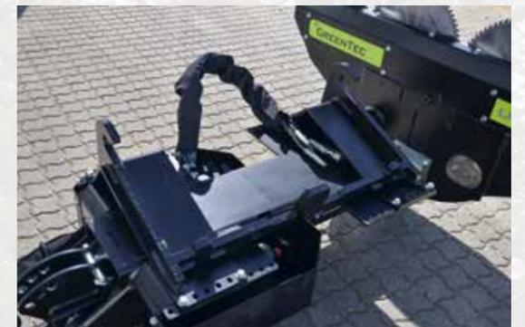
Die schräge Aufnahme erleichtert den Anbau der Astsäge.
