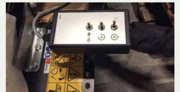
Über das elektrische Bedienpult laufen das Ein- und Ausschalten der Säge sowie die Steuerung des hydraulischen Kopfwinkels.
