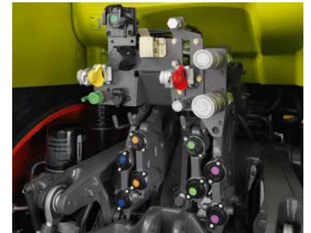
Mehr Leistung für die Hydraulikanlage: neue Steuergerätekonfigurationen und optional 150 Liter LS-Hydraulik
