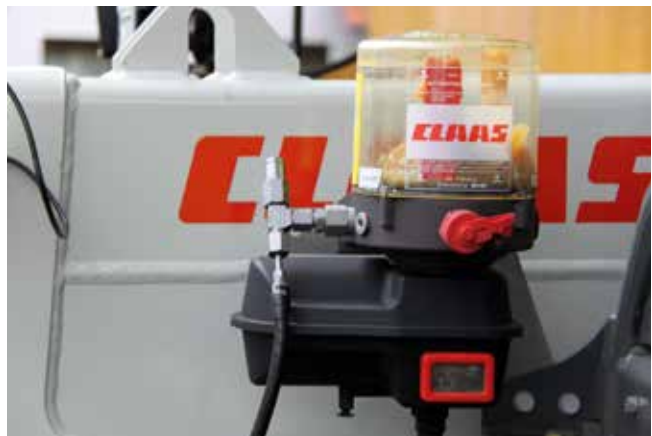
Die elektrisch angetriebene Schmierpumpe ersetzt die Fettpresse.
