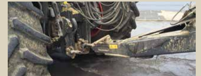
Bei der Zwangslenkung ist neben der K80 zwingend auch eine K50 Anhängung erforderlich.
