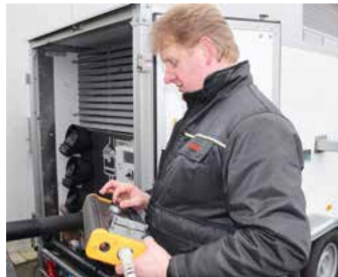
Die Leistung beider Traktoren wird gleich zu Beginn an der Motorbremse gemessen
