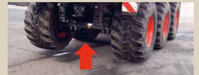
Bei Rückwärtsfahrt wird die erste Achse über die Knickdeichsel entlastet, und der Wagen kann in engen Situationen wie ein Tandem rangiert werden.
