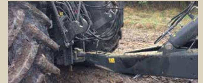
Ohne Zwangslenkung können mit der schmalen Deichsel große Lenkeinschläge gefahren werden.
